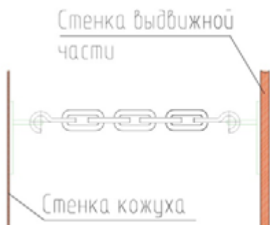
Рисунок 8 – Крепление выдвижной части шкафа
