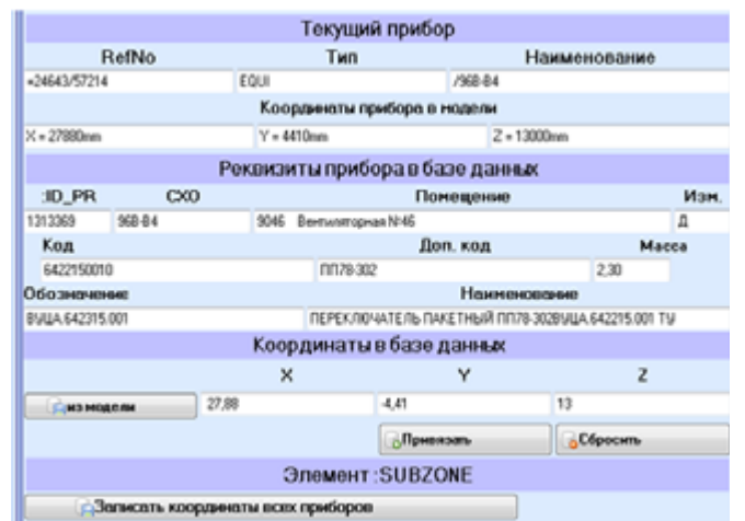
Рисунок 6 – Интерфейсы по взаимодействию «3D-модель – база данных»
