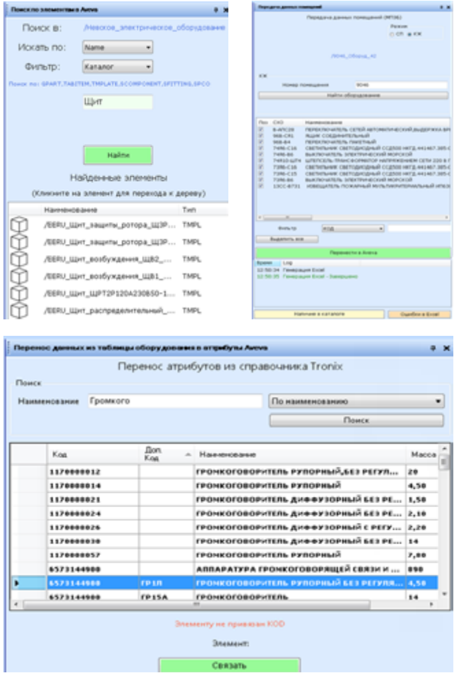
Рисунок 5 – Интерфейсы по взаимодействию «база данных – 3D-модель»
