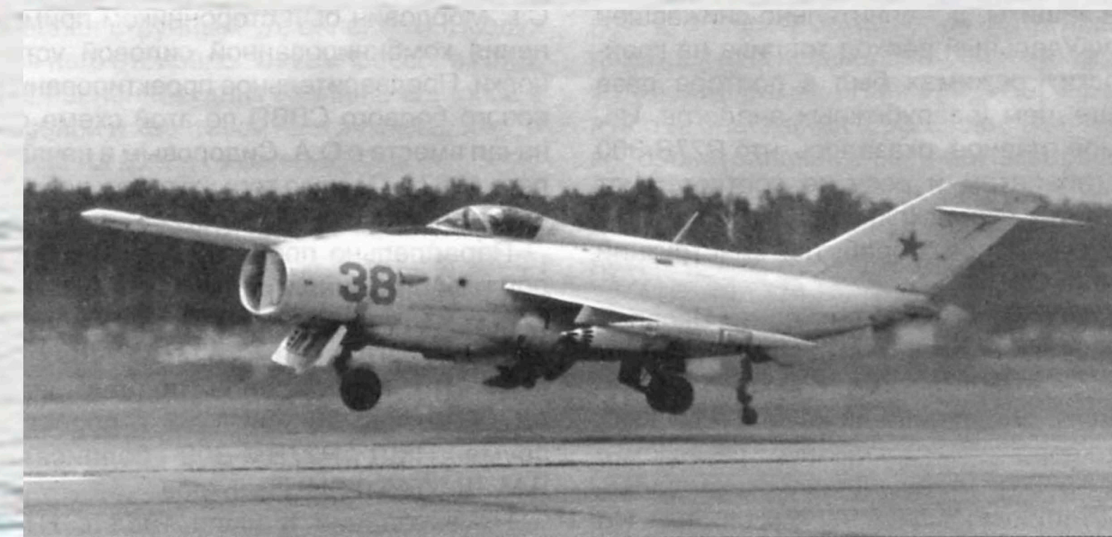
Вертикальный взлёт третьего экземпляра Як-36
